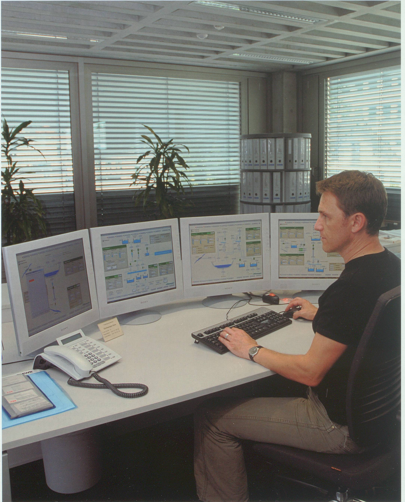
EWB Grünastrasse/Buchs: Steuer- und Leitsystem für die zentrale Verwaltung des Energieaustausches.
