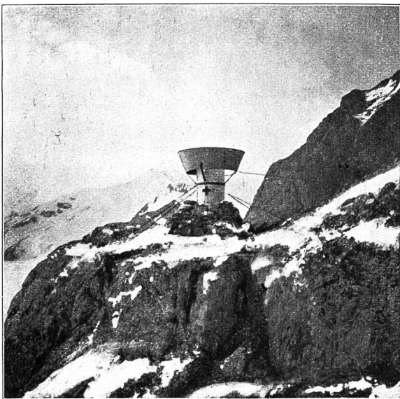
Abb. 1. Niederschlagssammler am obern Rhonegletscher (2860 m) erstellt von der Schweiz. Meteorol. Zentralanstalt. (Derselbe Typ am Jungfrauoch)
