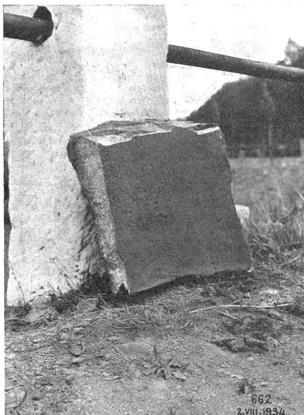
Abb. 10. Mexphaltbelag. Herausgespitztes Probestück. Außenseite.
