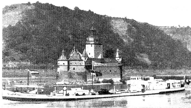
Abb. 33. Einschraubenmotortankschiff «Albatros», 600 t Tragfähigkeit, 300 P.S. Sulzer-Motor, gebaut nach den Plänen von Herrn Schiffbau-Ingenieur Ryniker, Eigentum der Tankschiff A.-G.
