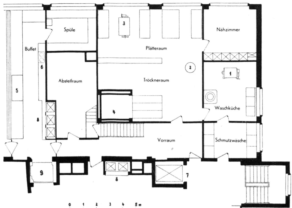
Fig. 38 Grundriss der Wäscherei
