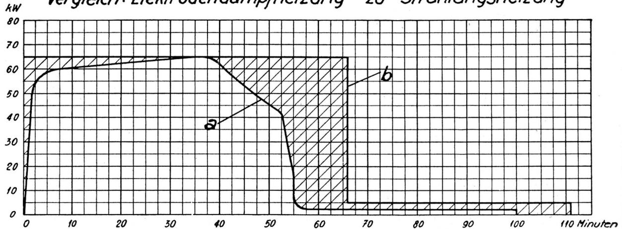
a Belastungskurve des Kochkessels mit Elektrodendampfheizung
