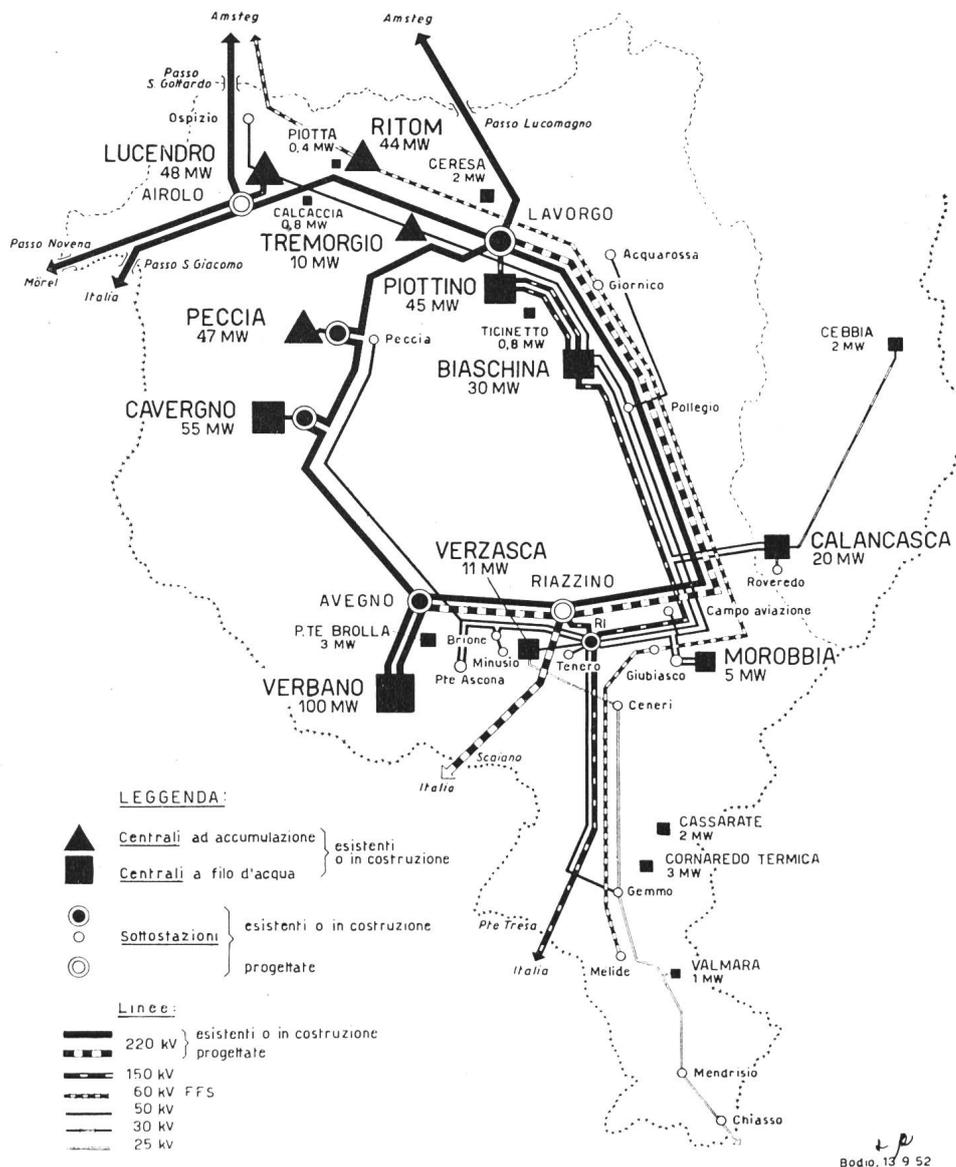
Abb. 14 Kraftwerkanlagen und wichtigste Verbindungsleitungen im Kanton Ticino
