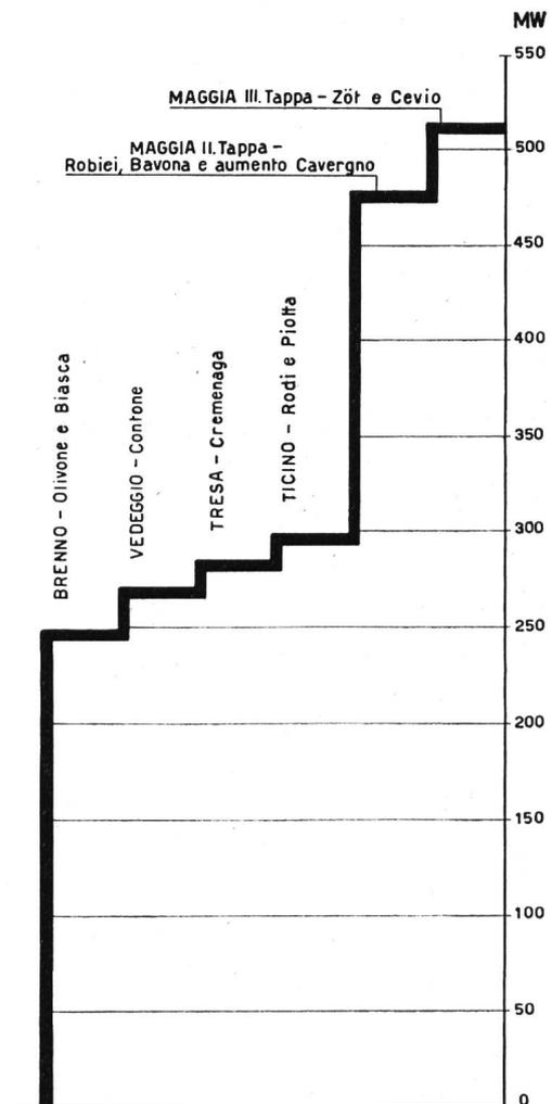
Abb. 12 Installierte Leistung der projektierten tessinischen Kraftwerke
