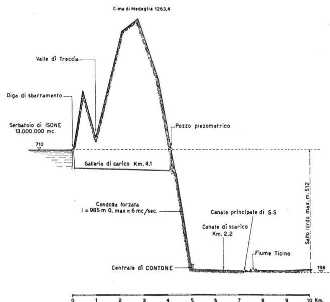
Abb. 9 Längenprofil der projektierten Wasserkraftanlage im Vedeggiotal
