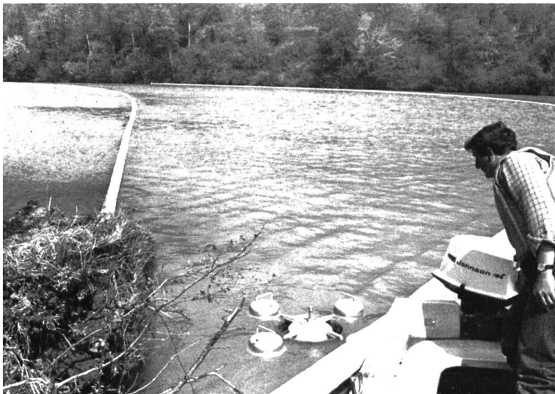
Bild 3 Verlegter luftgefüllter Schlauch (links) quer über den Rhein; im Vordergrund Schwimmgerät für das Absaugen der Oelschicht
