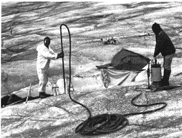
Bild 18 Thermischer Eisbohrer in Betrieb bei der Installation einer Abflussmessstelle auf dem Grossen Aletschgletscher. Das tragbare Gerät dient normalerweise zur Bohrung von Löchern bis zu 30 m Tiefe für das Einsetzen von Ablationsgestängen.
