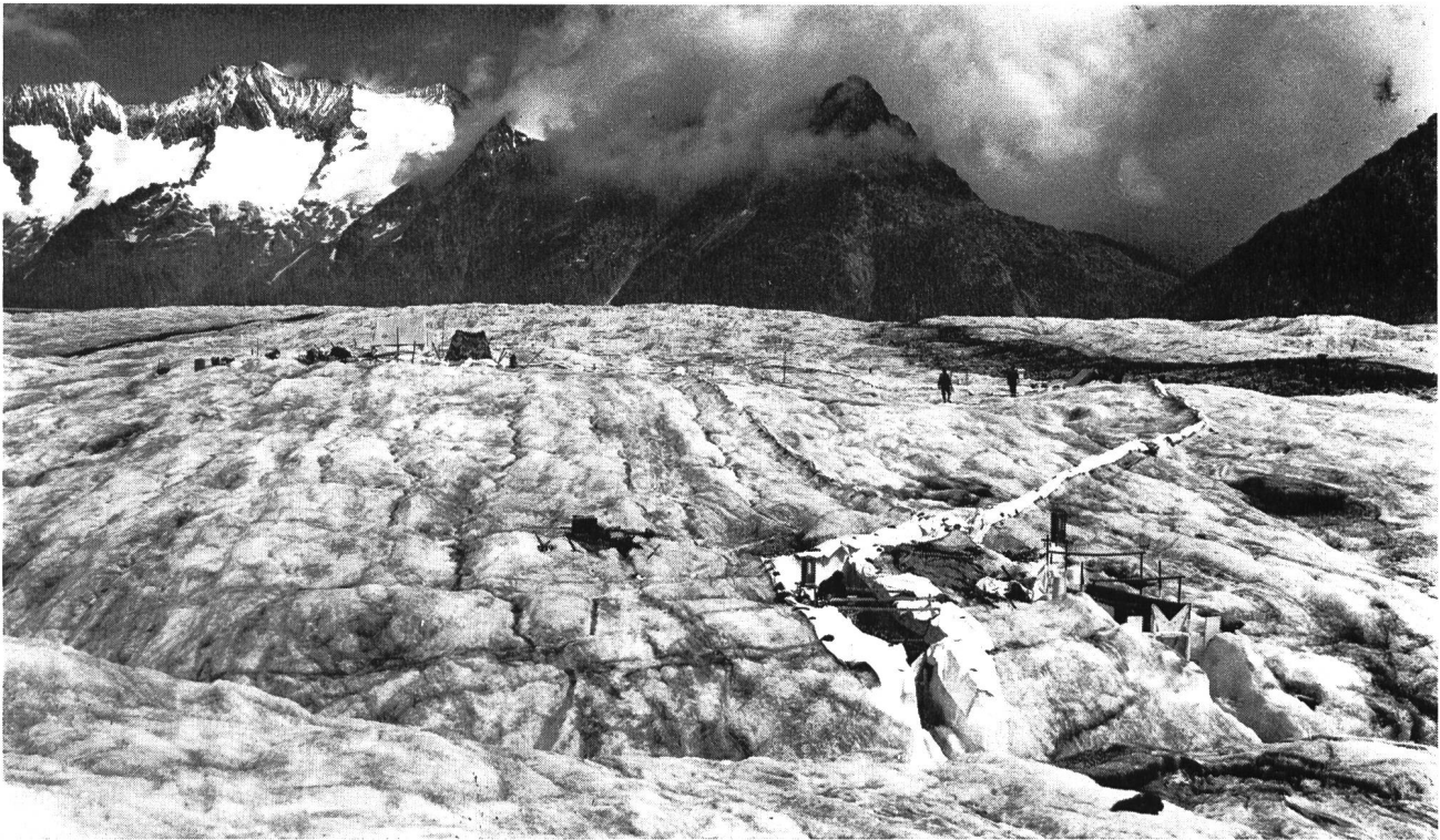
Bild 16 Grosser Aletschgletscher — Einzugsgebiet von 4500 m 2 , begrenzt durch Eisgrat unter weissem Syntosilstreifen als Strahlungsschutz auf 2200 m ü. M., zur vergleichenden Messung von Wärmebilanz, Ablation und Abfluss. — Im Vordergrund die Abflussmessstation.
