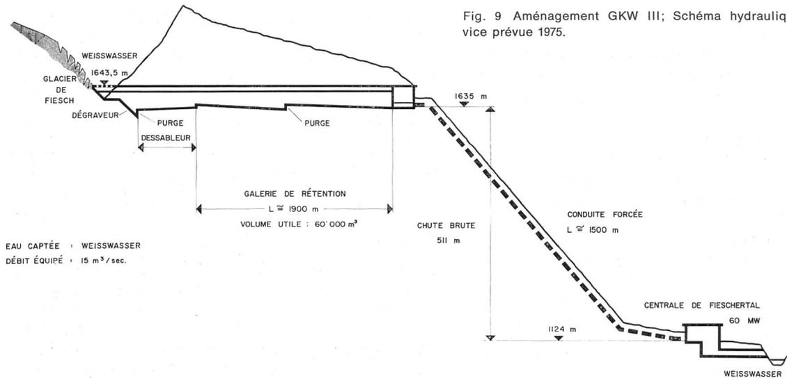
Fig. 9 Aménagement GWK III; Schéma hydraulique, mise en service prévue 1975.
