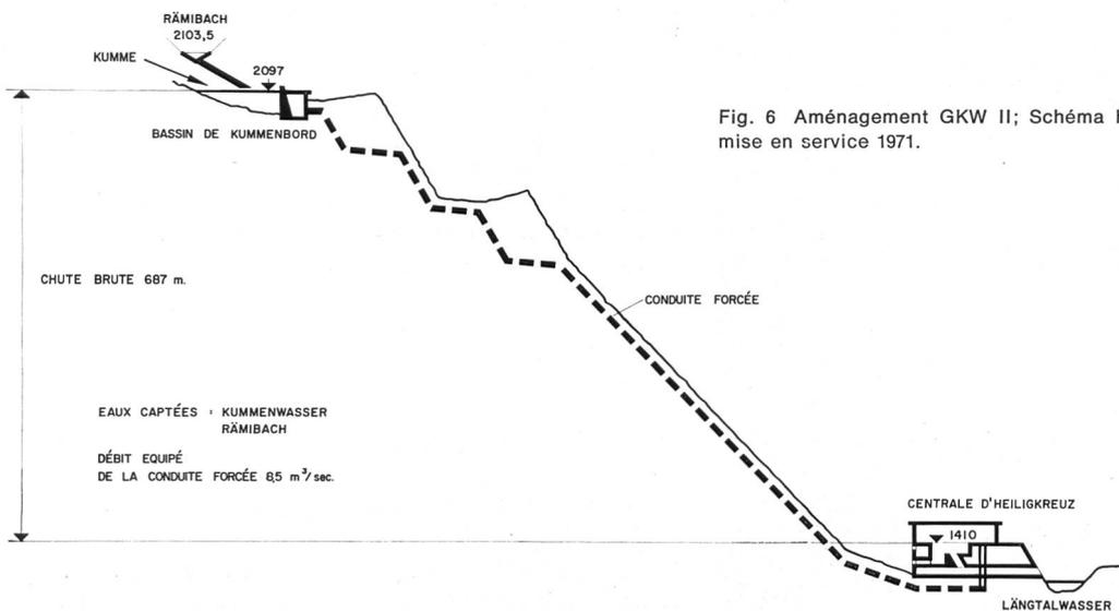
Fig. 6 Aménagement GWK II; Schéma hydraulique; première étape, mise en service 1971.
