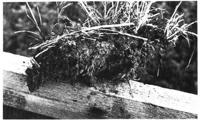
Bild 4. Oberflächenprobe nach der Kompostierung (2 Jahre).
