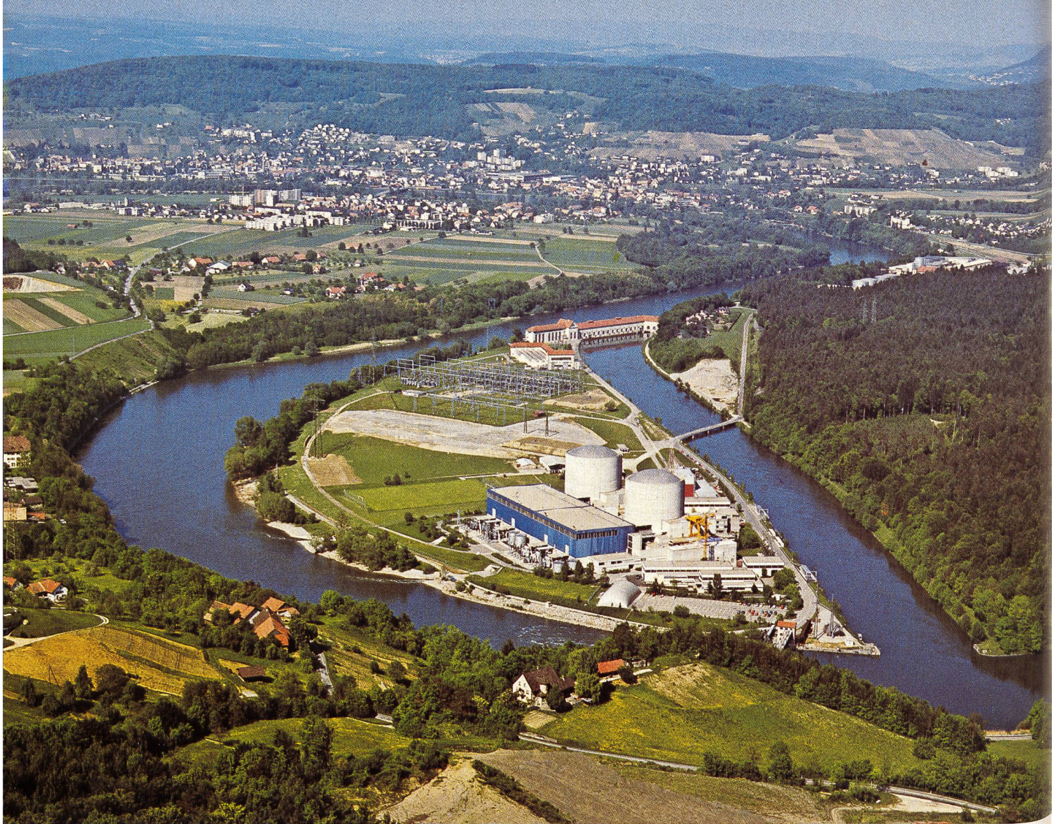
Bild 10. Flugaufnahme der Beznau-Insel, Blick gegen Nordosten. In der rechten unteren Ecke des Bildes trennt sich der Oberwasserkanal vom Aarelauf, er schneidet die Flussschleife ab. Die Wehraufbauten des Aarewehres sind gerade noch zu erkennen. Die Aareschleife wird vom Schloss Böttstein, am linken Bildrand, dominiert. Auf der Insel steht das Kernkraftwerk Beznau und die Freiluftschaltanlage. Dahinter schliesst das Maschinenhaus des Flusskraftwerkes Beznau den Oberwasserkanal ab. Im Hintergrund das Rheintal und die Höhen des Schwarzwaldes.
