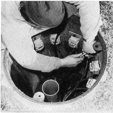
Bild 3. Schacht für die Messung der Temperaturen im Grundwasser mit Anschlussdosen für die Messwerterfassung in verschiedenen Tiefen. Unten im Bild ist das festeingebaute Messrohr sichtbar.
