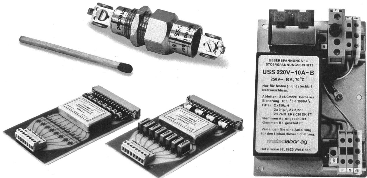
Bild 4. Im Handel erhältliche Schutzschaltungen (Werkbilder Meteolabor). Links oben: Durchführungs-Schutzschaltung, Betriebsspannung 6/12/24/150 V, Ableitstromsstrom 25 kA (Form 8/20), Restspannung bei Überspannung < 2 \times Betriebsspannung. Links unten: Schutzschaltungen für acht unabhängige Signalleitungen und für vier Doppeladern auf Europakarten. Rechts: Schutzschaltung für 220 V~/10A, Ableitvermögen 25 kA (Form 8/20).
