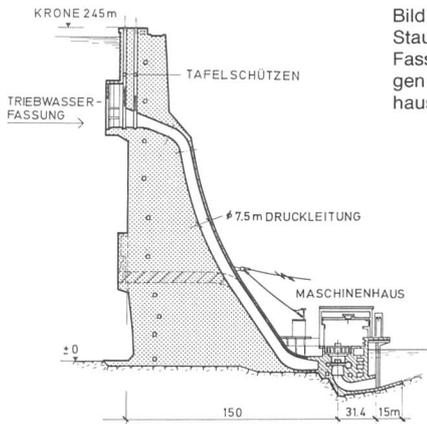
Bild 2. Schnitt durch die Stauanlage im Bereich der Fassung, der Druckleitungen und des Maschinenhauses.
