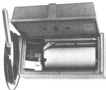
pha-S zusätzlich mit einer Temperaturregistrierung ausgerüstet. Zudem kann der Pegel an eine Fernübertragungsanlage oder einen elektrischen Datensammler angeschlossen werden. Die modernen, formschönen Gehäuse aus Aluspritzguss mit wetterbeständigem Hammerschlaglack, Türe massiv oder mit Sichtfenster, entsprechen dem bewährten Typ Alpha.
