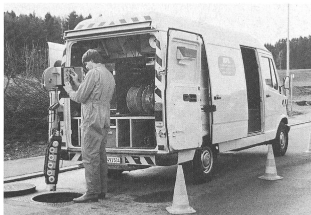
Bild 1. KFS-Kanalfernseh-Fahrzeug mit Kamerawageninstallationen.
