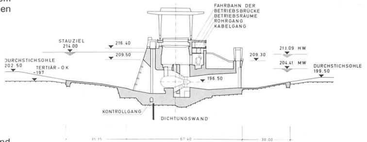
Bild 7. Krafthaus des Laufkraftwerks, Querschnitt.
