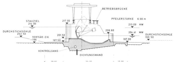
Bild 8. Wehranlage der Staustufe, Querschnitt.
