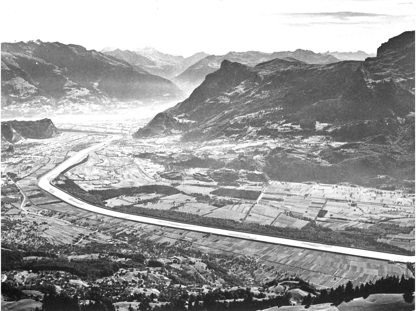
Bild 1. Alternierende Bänke im Alpenrhein. Abschnitt bei Trübbach (SG), in dem ergänzende Naturmessungen durchgeführt wurden (Foto W. Wachter, FL- 9494 Schaan).
