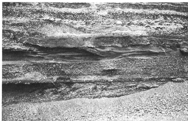
Bild 1. Blick in eine Kiesgrube mit Wechsellagerung von Kies- und Feinsandschichten sowie Deltalagerung, das heisst schiefgestellte Schichtpaketen. Foto E. Trüeb
