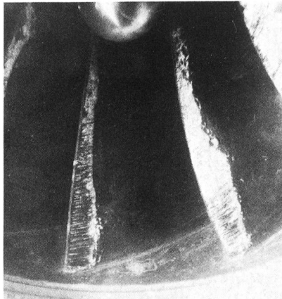
Figure 1, à gauche. Bulles de cavitation à la sortie d'une roue d'un modèle réduit de turbine Francis.
