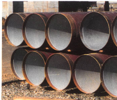
Zementmörtelbeschichtung von Trinkwasserrohren
