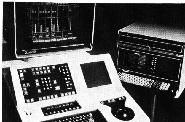
Bild 1. Bedienstation für das Prozessleitsystem RS3.
