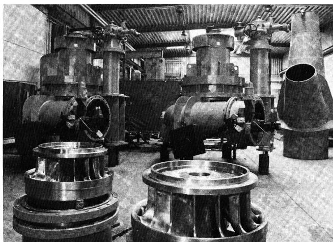
Francis-Kompaktturbinen 84 kW, Peru
