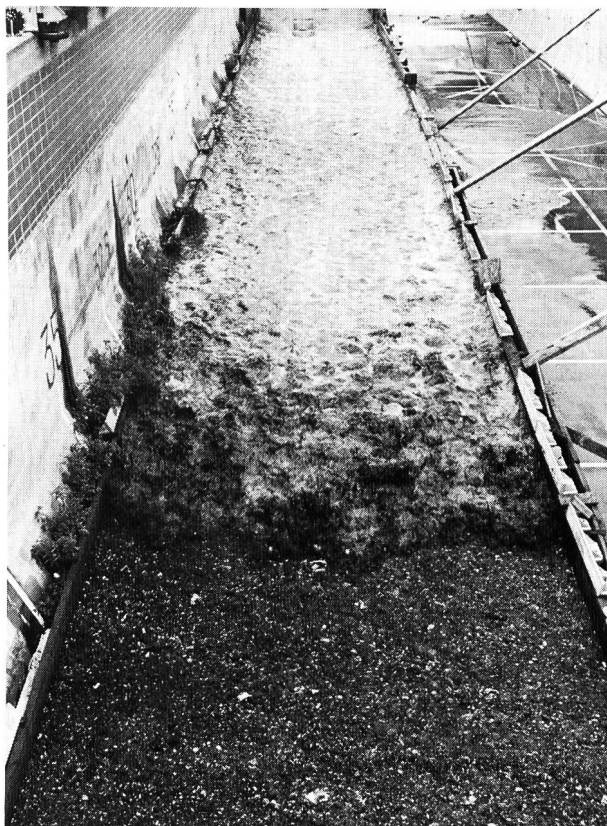
Bild 8. Derselbe Vorgang, wie in Bild 7 gezeigt, aus frontaler Sicht. Obwohl die Front bereits ca. 36m durchgemessen hat, bleibt sie symmetrisch und weist eine ausgeprägte Spülkraft auf. Zum Zeitpunkt, wo die Spülfront das Beckenende erreicht hat, ist der Kasten noch zu etwa einem Drittel gefüllt.
