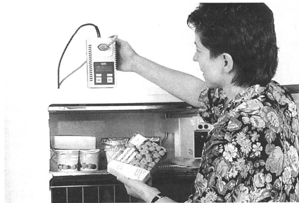
Bild 1. Um den Stromverbrauch des Kühlschranks festzustellen, genügt ein Messgerät, das zwischen Steckdose und Kühlschrank geschaltet wird. Das EWZ leiht solche Messgeräte kostenlos aus.
