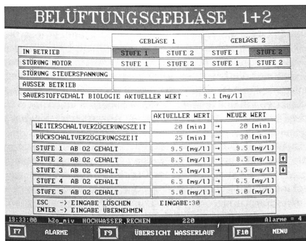
Bild 4. Störungsmeldungen wie auch Betriebswerte können auf den Bildschirm geholt werden. Wenn nötig, werden die Daten auch noch ausgedruckt.
