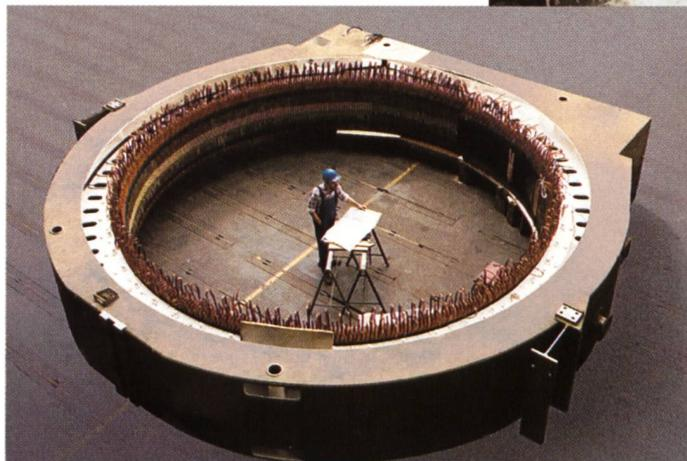
Unser Foto zeigt eine Werkan-sicht des einteiligen, fertig geblechten Stators mit seinen Auflagefüssen und der schon teilweise eingebauten Wicklung. Die ausgeprägten lamellierten Rotorpole mit vollständiger Dämpferwicklung sind direkt auf dem Turbinen-Aussenkranz montiert, der auch die Schleifringe trägt und gleichzeitig als Generator-Polrad dient.
