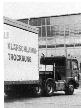
Bild 2, rechts. Transport einer mobilen Klärschlamm-trocknungsanlage mit Tieflader. (Fotos: U. Ammann)
