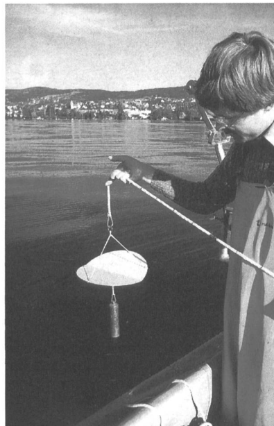
Bild 1. Die Secchi-Scheibe wird immer tiefer ins Wasser gelassen, bis sie nicht mehr sichtbar ist. Diese Tiefe und die Tiefe des Sichtbarwerdens beim Wiederauftauchen der Scheibe werden gemittelt, was ein Mass für die Lichtdurchlässigkeit des Wassers gibt.
