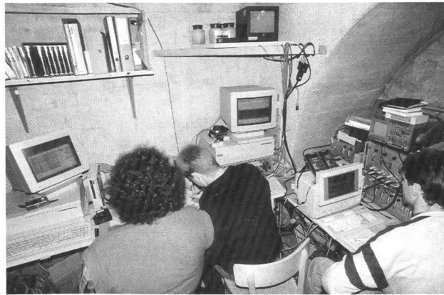
Bild 2. In der Grundablasskammer waren 3 Messcomputer inkl. Verstärker und Filter und 2 Videorecorder mit Monitor installiert. 1 Computer diente der dynamischen Erfassung der Wasserdrücke (22 Drucksonden), 1 Computer zur Messung der Luftdrücke (6 Drucksonden) sowie der Luftgeschwindigkeit (3 Messflügel in der Belüftungsleitung und 1 Messflügel im Grundablassstollen). Mit dem 3. Computer wurde die Luftkonzentration an 6, die Geschwindigkeit des Wasser-Luft-Gemisches an 4 Stellen messtechnisch erfasst. (Foto J. Speerli, VAW)
