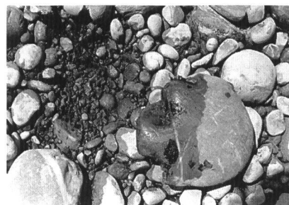
Bild 1a, links. Oberfläche einer unkolmatierten Sohle.
