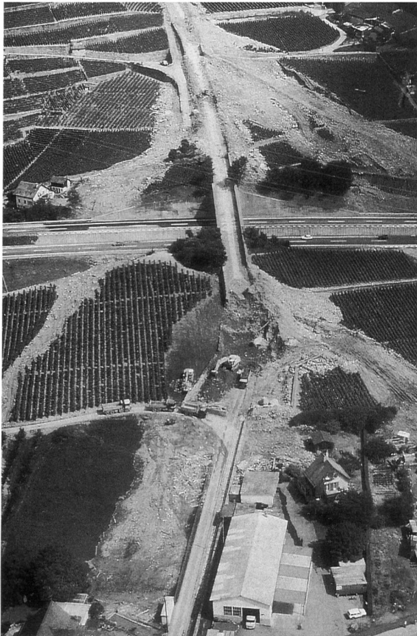
Bild 7. Der Murgang bei Villeneuve VD Mitte August 1995. Die Foto zeigt die Geschiebeausbrüche des «Pissotbaches» ober- und unterhalb der Genfersee-Autobahn. (Foto: Landeshydrologie und -geologie LHG, Ch. Lehmann, Bern)
