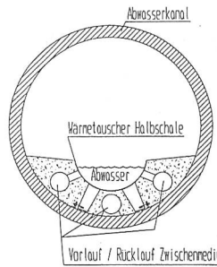
Bild 3, links. Die Wärmetauscher werden elementweise eingebracht und justiert. Unten: Vor- und Rücklaufleitung (IBA Stadt Zürich).
