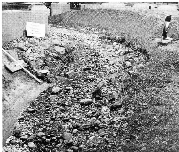
Bild 18. Lage der Würfel nach Durchgang eines extremen Hochwassers (Göschenen-Stäfeligand; Foto: VAW).
