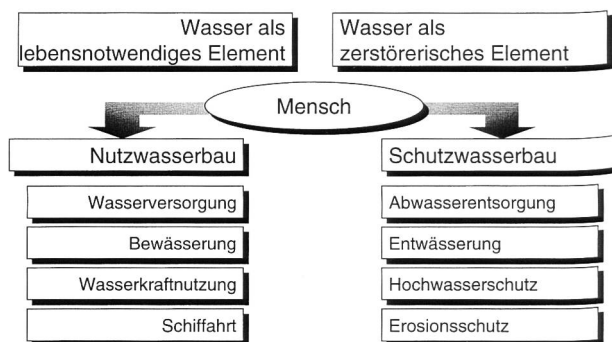
Bild 1. Bereiche des Nutz- und Schutzwasserbaus.
