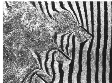
Bild 5. Sequenz von vier Strömungsbildern für die schwingende 3-Stab-Konfiguration mit Stababstand 2e und einem Anströmwinkel von \alpha = 45^\circ . Unten die Schwingellipse.
