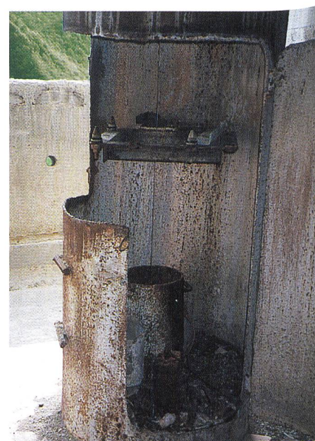
Bild 2. Detail eines Lotes zur Verformungsmessung.
