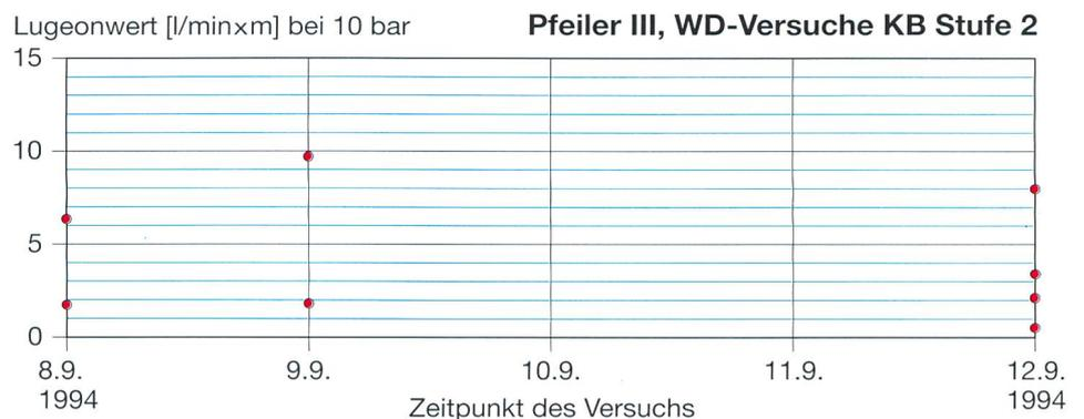
Bild 6.7. Ergebnisse der WD-Versuche nach Abschluss der Injektionen.
