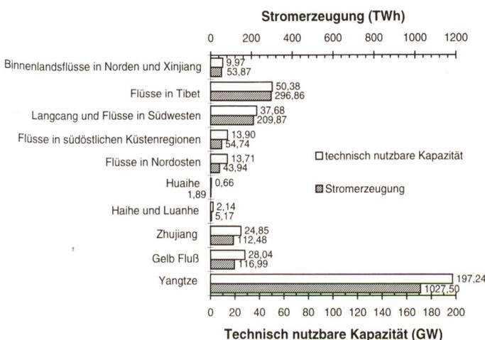
Bild 1. Technisch nutzbare Wasserkraftressourcen der Flusssysteme in China.
