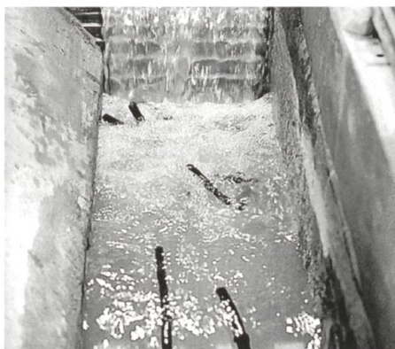
Bild 13. Schwemmholz im Tosbecken bei Q_z = 3,0 \text{ m}^3/\text{s} .
