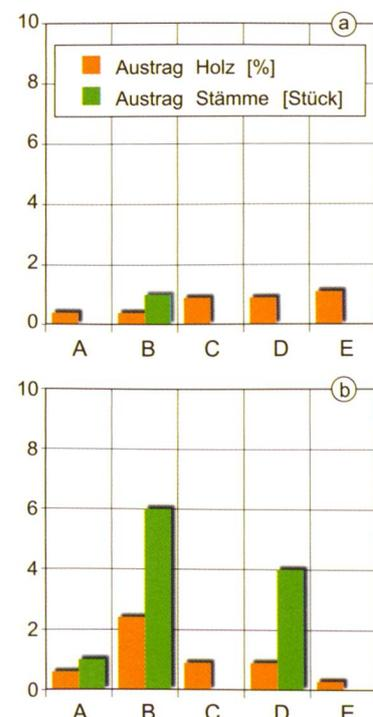
**Bild 4.** Holzdurchgang für die Rechentypen aus Bild 3 für den Grenzlastfall und eine Schwemmholzzufuhr von 500 m<sup>3</sup> (Festmeter). a) Fall ohne b) Fall mit Rückstau. Stämme sind Hölzer über 2,3 m Länge.
