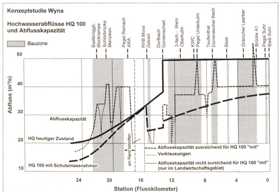
**Bild 10. Rückhaltebecken Moos, Abminderungswirkung für die Abflussspitze.**
