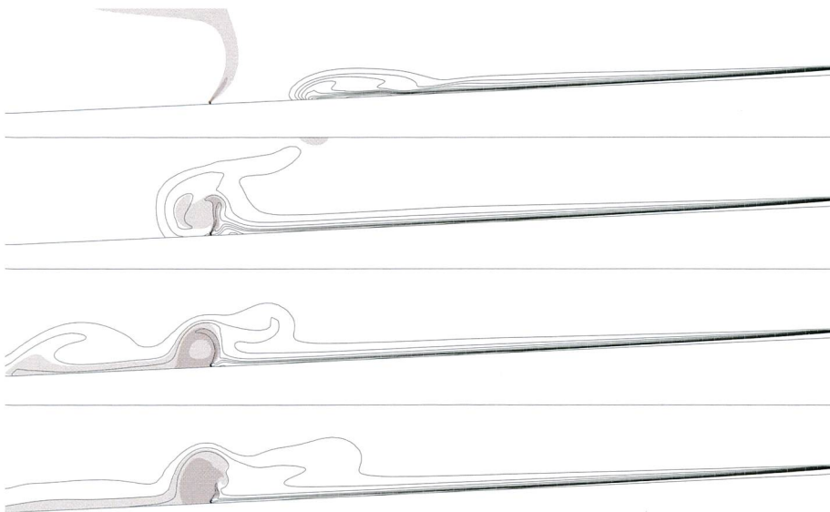
Bild 16. Simulation eines durch einen 45° aufwärts gerichteten Wasserstrahl fließenden Trübestroms in Zeitintervallen von 20 s. Die Linien gleicher Sedimentkonzentration sind mit einem Intervall von \Delta c = 0,1 \text{ g/l} dargestellt, wobei die oberste Linie einer minimalen Konzentration von 0,1 \text{ g/l} entspricht (Versuch E01).
