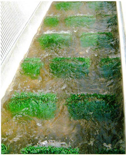
Bild 3. Abflussverhältnis in einem Borstenfischpass mit 8% Längsgefälle/200 l/s.
