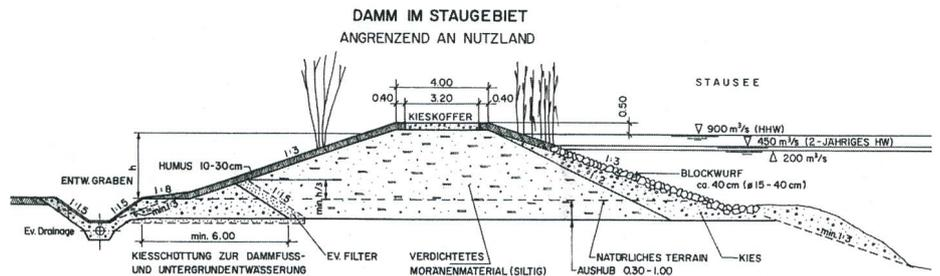
**Bild 1. Längsdamm einer Stauhaltung – typischer Querschnitt mit Blockwurf, darunter liegender Filterschicht, verdichteter Moräne als Dichtung, Drainagekeil mit Filterschutz und Drainagegraben.**
