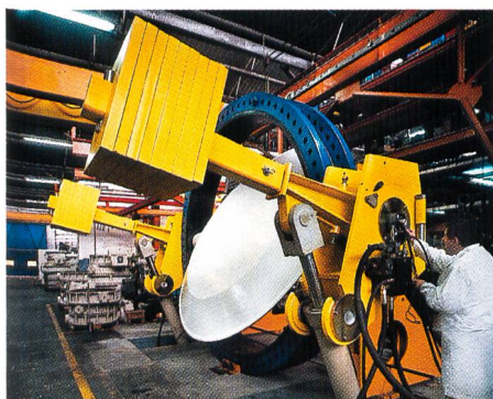
Bild 1. Die neuen Stellantriebe mit Gegengewichten von KSB arbeiten entweder als Rückschlagklappe oder Sicherheitsarmatur (Foto: KSB Aktiengesellschaft, Frankenthal).
