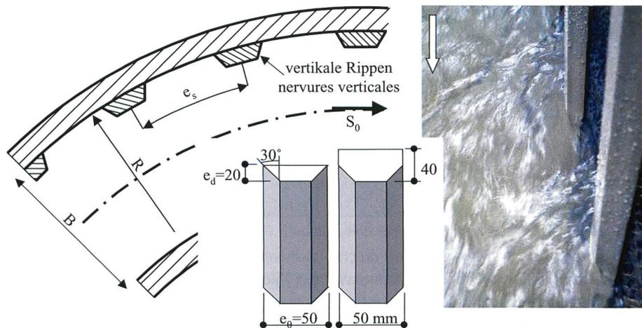
**Bild 3. Anordnung und Geometrie der Makrorauigkeit und Strömung um die Rippen.**
