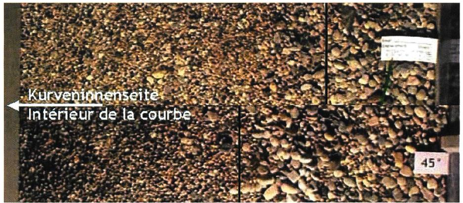
**Bild 4. Sortierungsprozess in Querrichtung; ohne Rippen (oben), mit Rippen (unten).**
