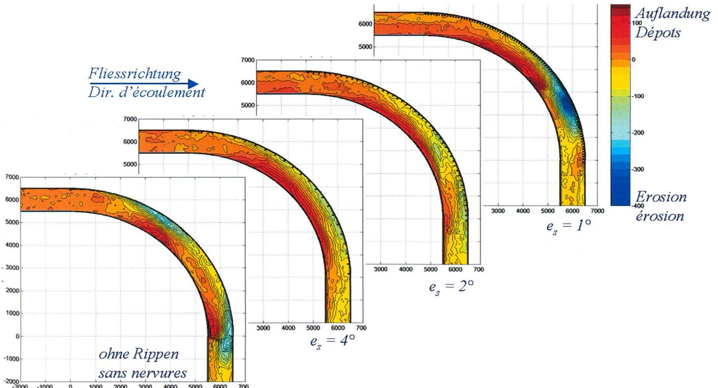
**Bild 5. Vergleich der Sohlenlagen nach Versuchen mit  $Q = 210$  l/s bei einem Gefälle von 0,5%.**
