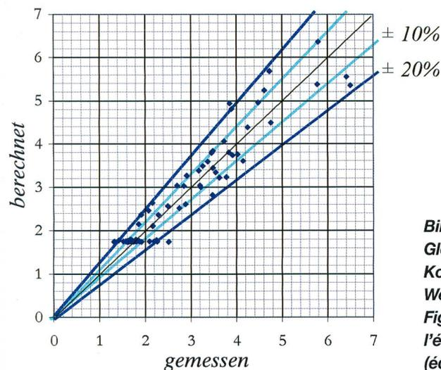
**Bild 9. Vergleich der mit der Gleichung (4) berechneten Kolkiefen mit den gemessenen Werten.**
