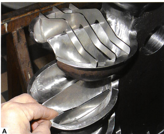
Bild 3. PT-Prüfung der Schaufelbecher der neuen Peltonturbinen: A) Prüfung auf Lehrenhaltigkeit, B) PT-Prüfung.
