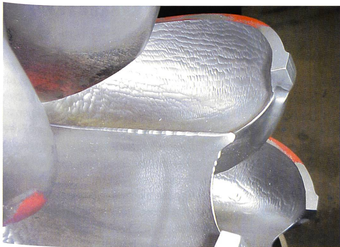
Bild 6. Schäden im Innern der Becher der Peltonurbine des Kraftwerks Kandergrund.
