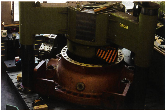
Bild 8. Ausdrehen des Schiebergehäuses.
