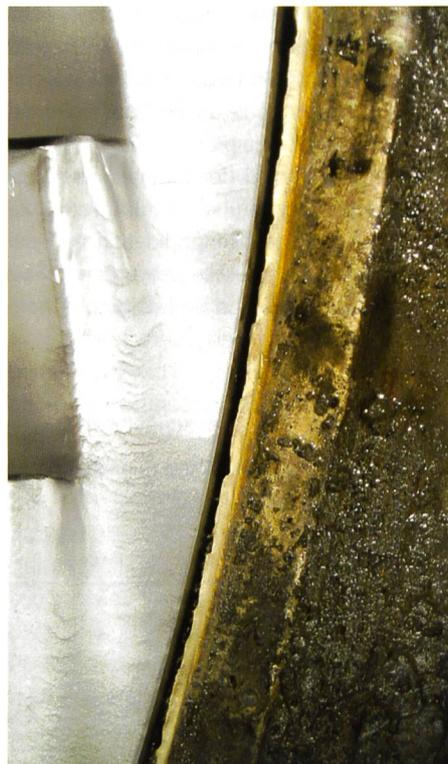
**Bild 10. Auswaschungen im Labyrinthspalt.**
