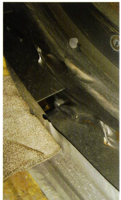
**Bild 11. Sandschleifschäden an Leitschaufeln und Schutzring.**
